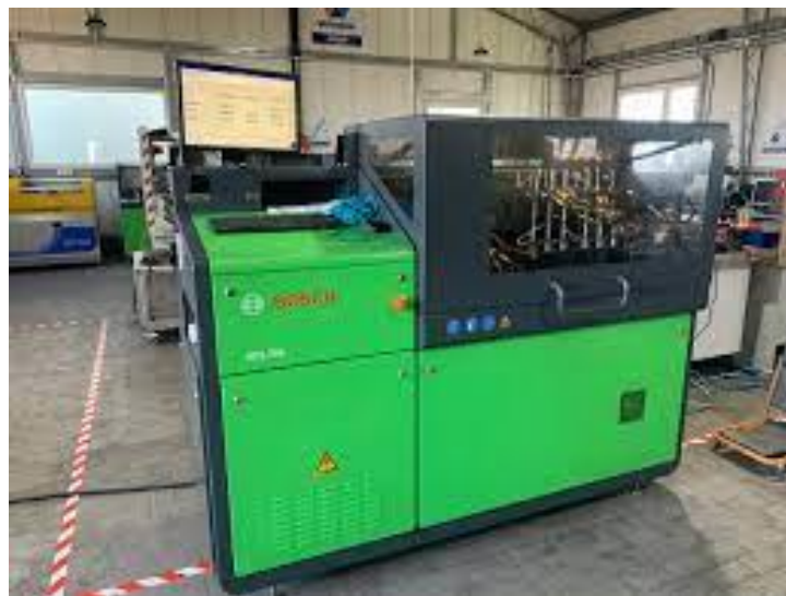
Рис. 2.5. Загальний вигляд стенду EPS 708 з безмензурочною електронною вимірювальною системою КМА 802
