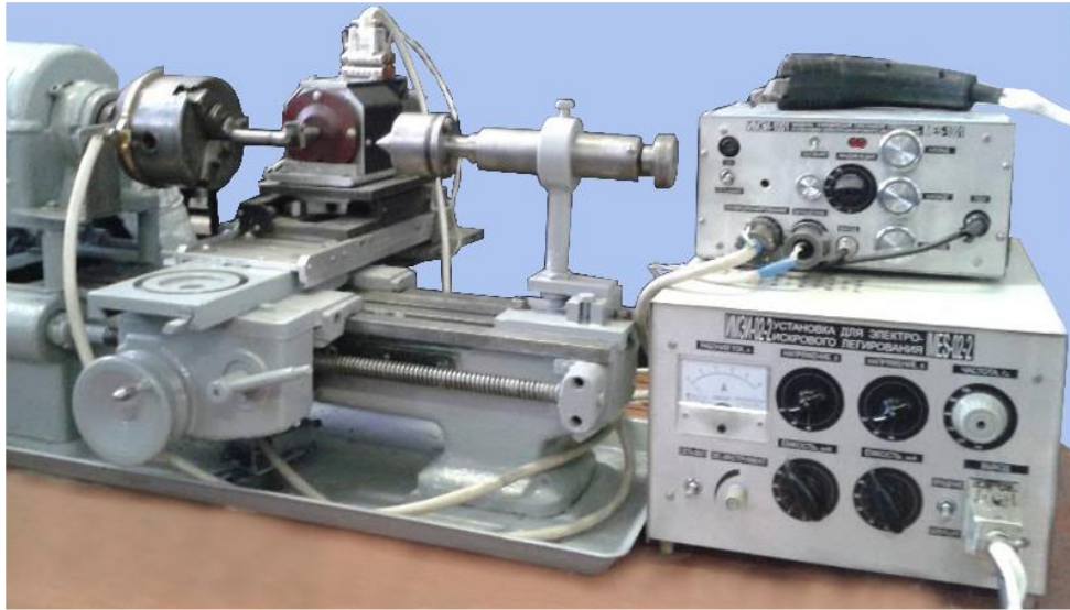
Рис. 2.6. Загальний вид механізованої установки ІМЕІ-1001-ІМЕС на базі токарного верстата
