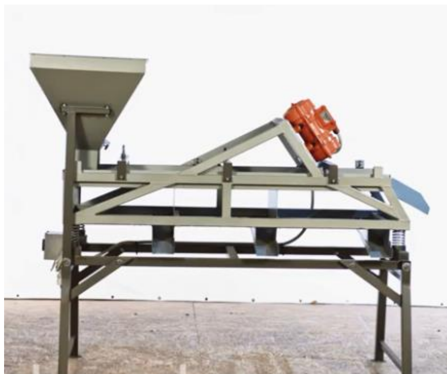
Рис. 2.4 Вібросито для сортування ядра горіха
