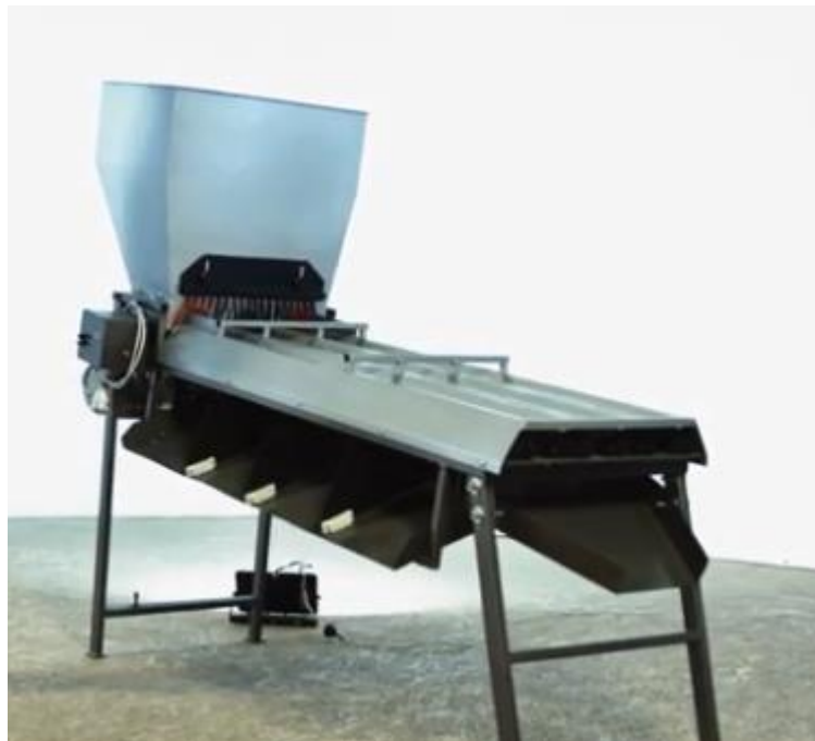
Рис. 2.2 Лінійний калібратор горіхів
