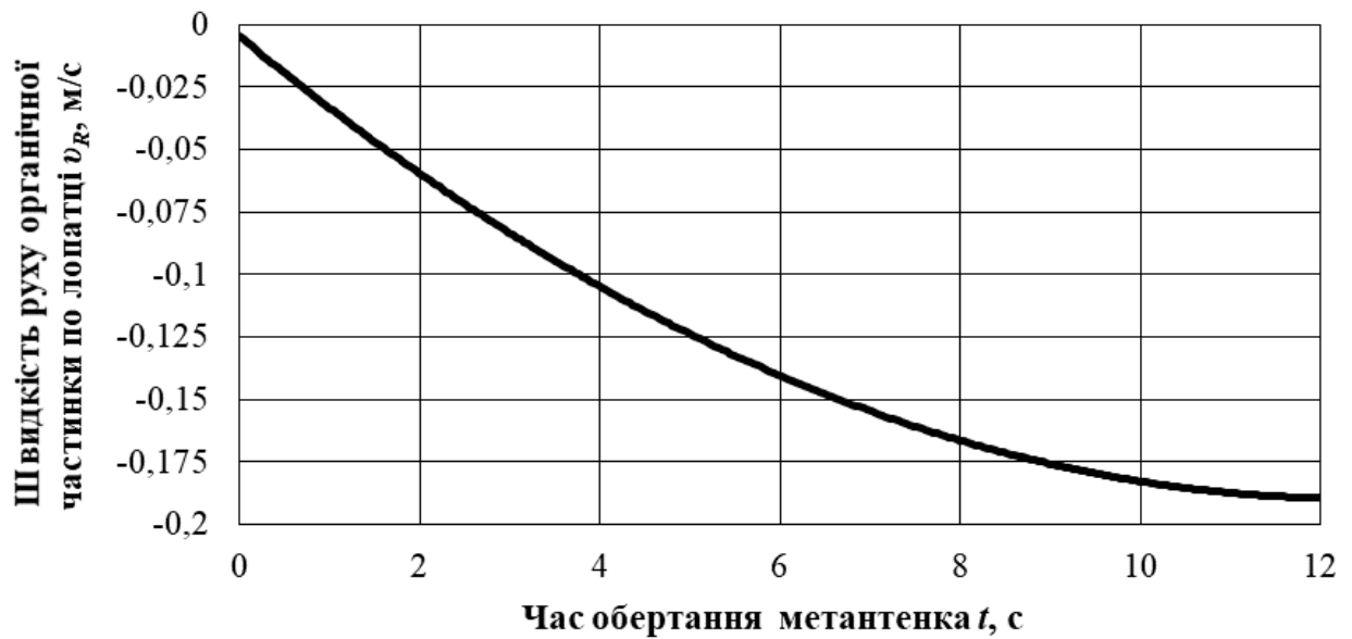
Рис. 3.4. Переміщення та швидкість органічних частинок субстрату по поверхні лопатей-лез всередині біореактора
