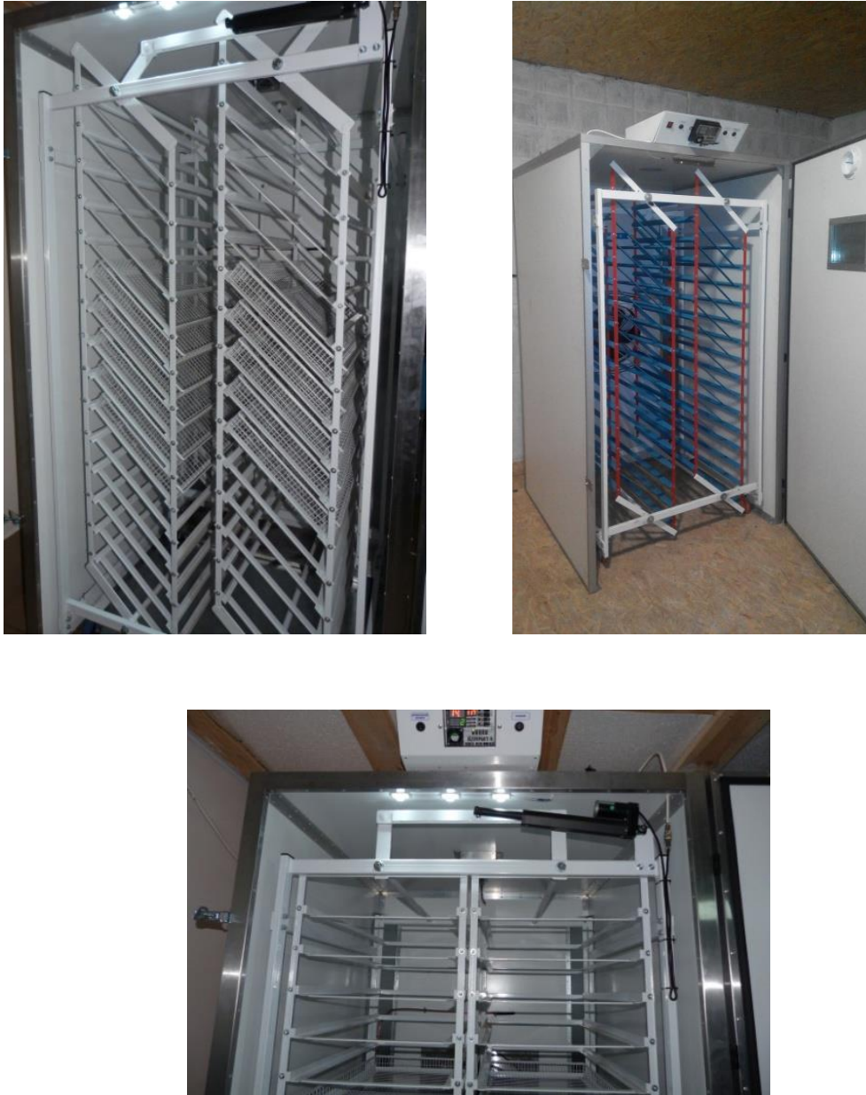
Рис. 12. Обладнання інкубатора «Etalon-5000»
