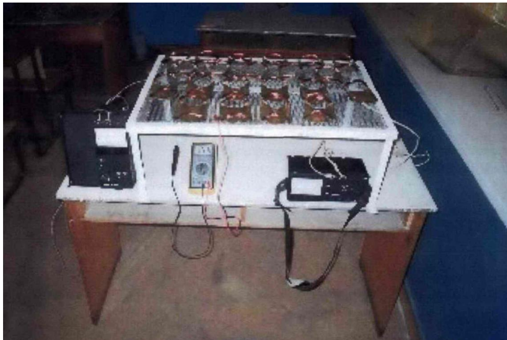
Рис. 3.1. Фотографія експериментальної установки для визначення вологостійкості ізоляції
