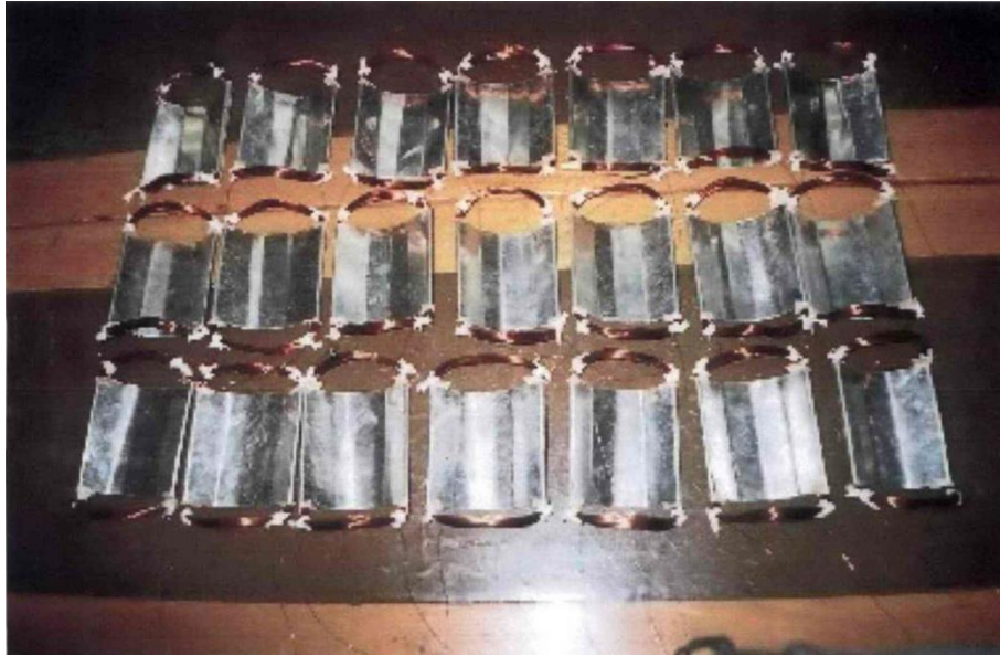
Рис. 2.5. Фотографія експериментальних зразків секцій статора обмотки АД.
