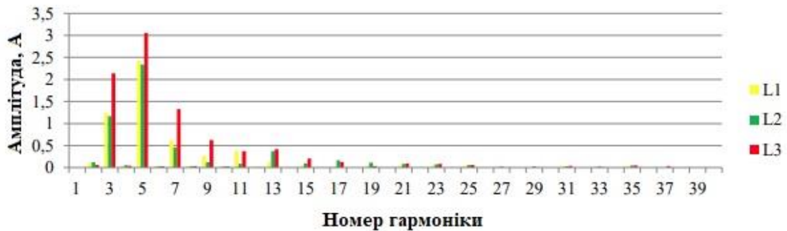
Рисунок 1.3. Спектр гармонік струму на шинах 0,4 кВ ТП-1 при максимальному завантаженні трансформатора
