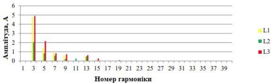
Рисунок 1.4. Спектр гармонік струму на шинах 0,4 кВ ТП-2 при максимальному завантаженні трансформатора
