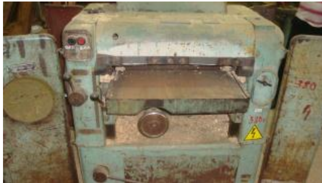
Рис. 2.4. Рейсмусовий верстат CP-9
