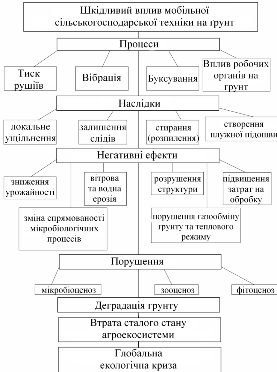
Рис. 3.1. Структурна схема впливу рушіїв на ґрунт та його наслідки
