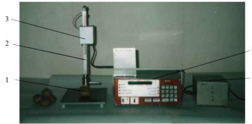
Рис. 2.1. Прилад "Клубінь" ПРГ – 401: 1 – клубіть; 2 – вимірювальний щуп; 3 – вимірювальний блок; 4 – блок керування; 5 – блок живлення.
