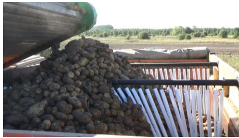
Рис. 3.8. Завантаження автомобіля МАЗ 5516, обладнаного поперечними еластичними перегородками
