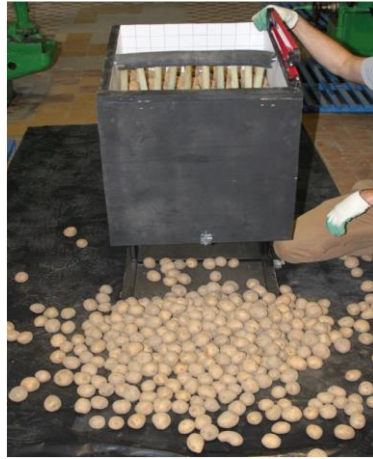
Рис. 2.4. Загальний вигляд контейнера, обладнаного еластичною перегородкою при дослідженні гуркоту бульб картоплі.
