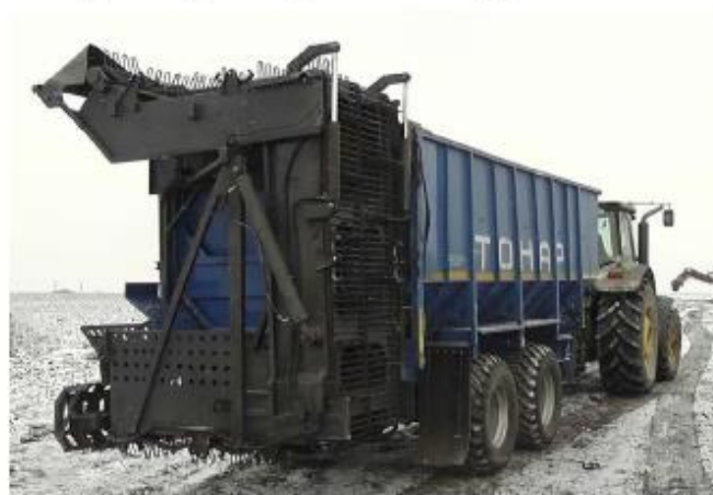
Рис. 1.4. Транспортний засіб, обладнаний вивантажним транспортером
