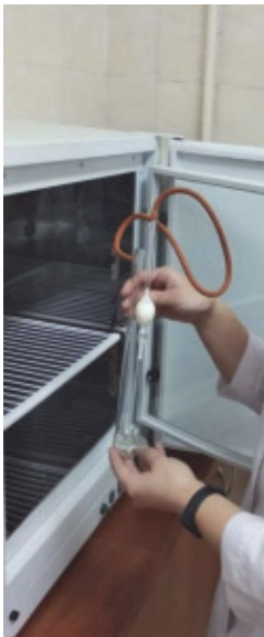
Рис. 2. Вимірювання умовної в'язкості на віскозиметрі Освальда
