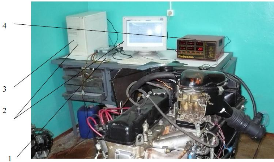
Рис. 2.3. Вимірювально-реєструючий комплекс: 1 – блок живлення; 2 – системний блок із монітором; 3 – АЦП; 4 – газоаналізатор Інфракар М1-01.
