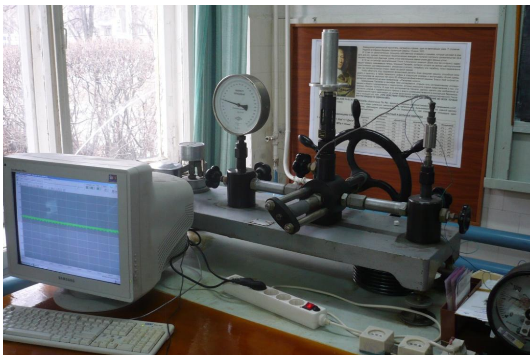
Рис. 2.9. Тарування каналів реєстрації тиску газів
