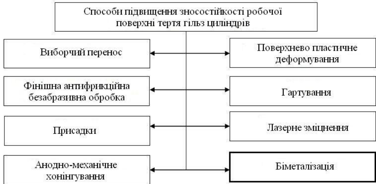
Рис. 1.3. Способи підвищення зносостійкості робочої поверхні тертя гільз циліндрів [3,5, 7, 8, 8-11]
