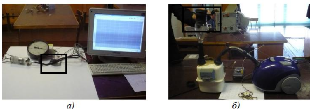
Рис. 2.8. Способи тарування: а) датчик розрядження BOSCH 4513829; б) датчик масової витрати повітря BOSCH 0280218037.
