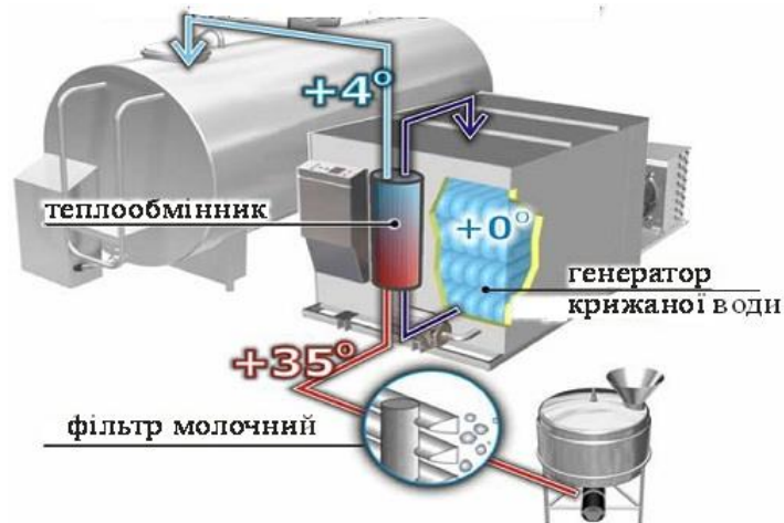
Рисунок 1.3. Схема охолодження молока з непрямим охолодженням
