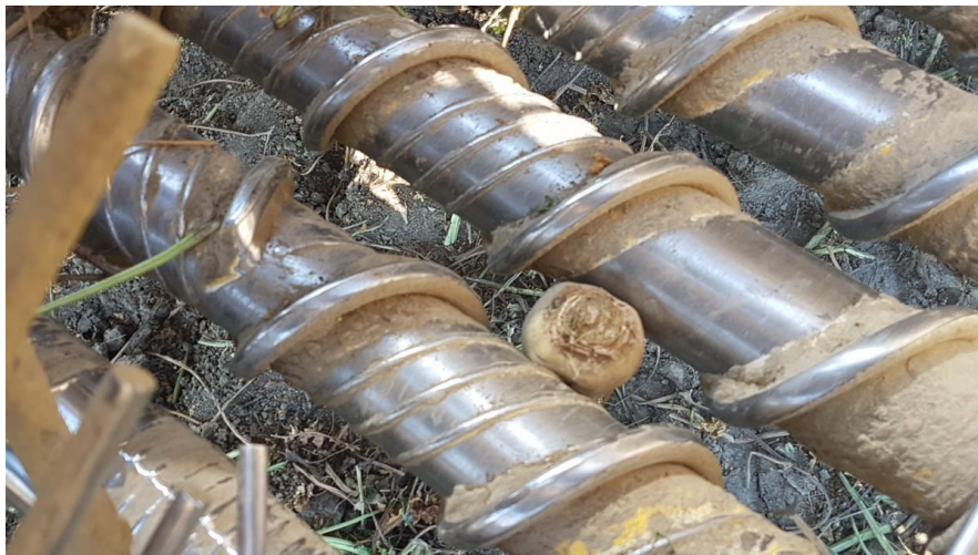
Рис. 3.6. Підйомні шнекові вальці зі стандартним зовнішнім діаметром
