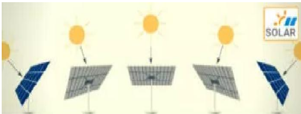
Рис 2.3. Робота трекера протягом дня [7]
