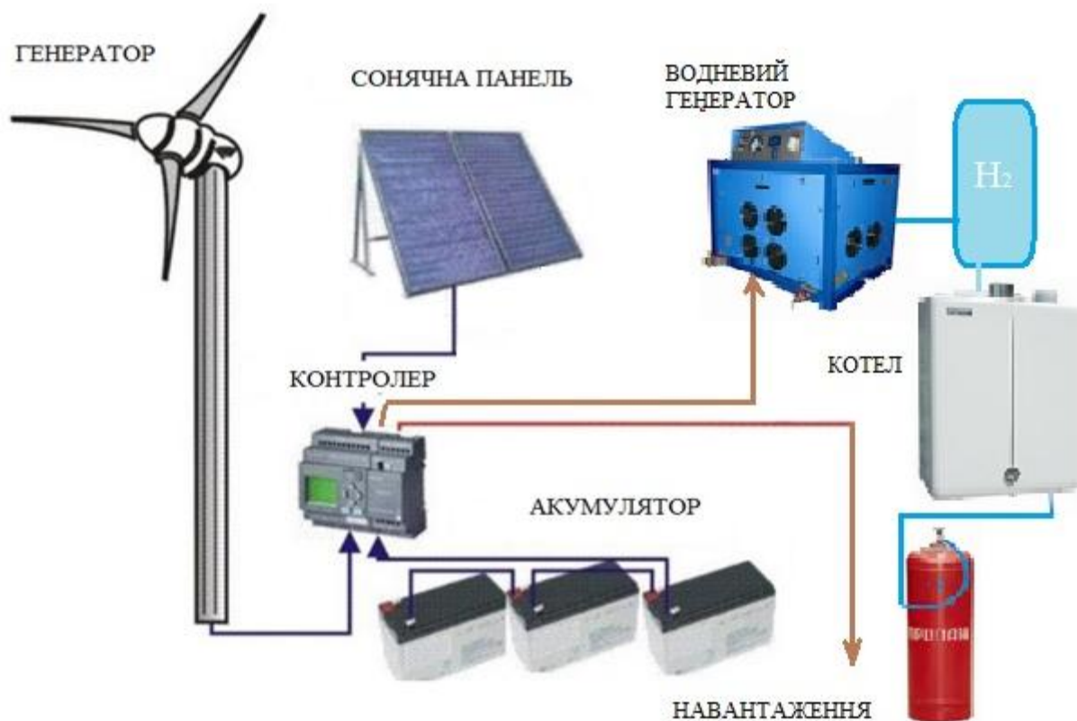
Рис. 3.4. Енергетичне обладнання для забезпечення роботи ферми [12]
