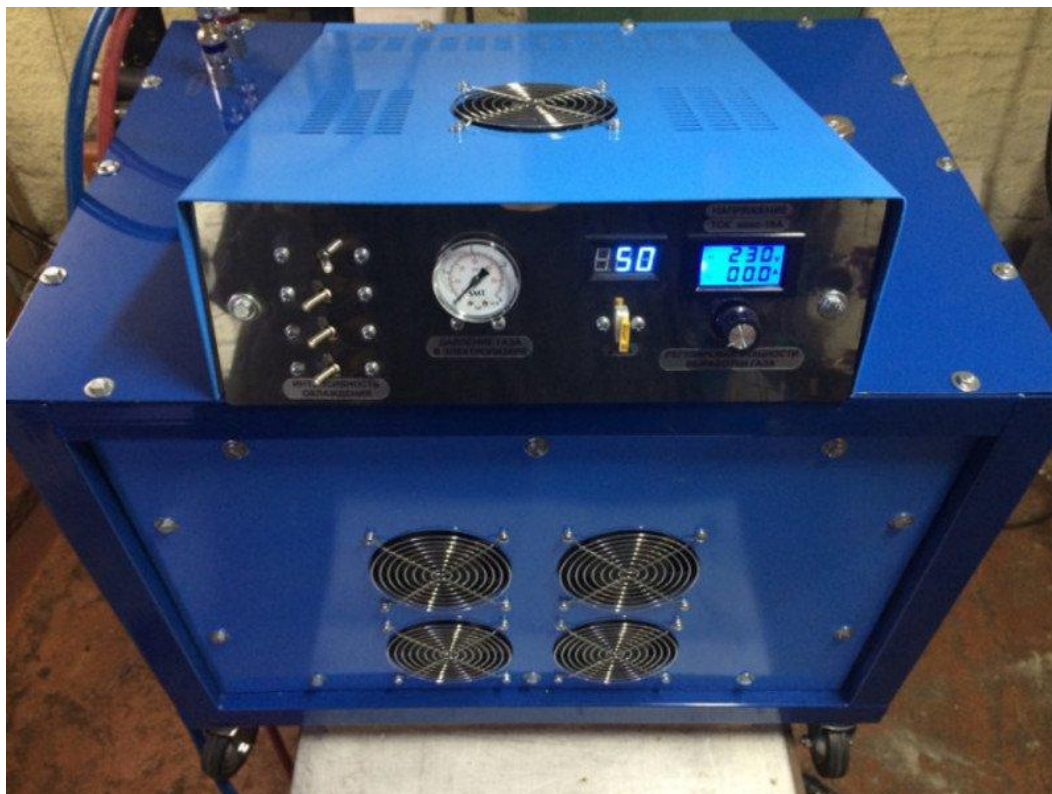
Рис 3.2. Електролізер для виділення водню
