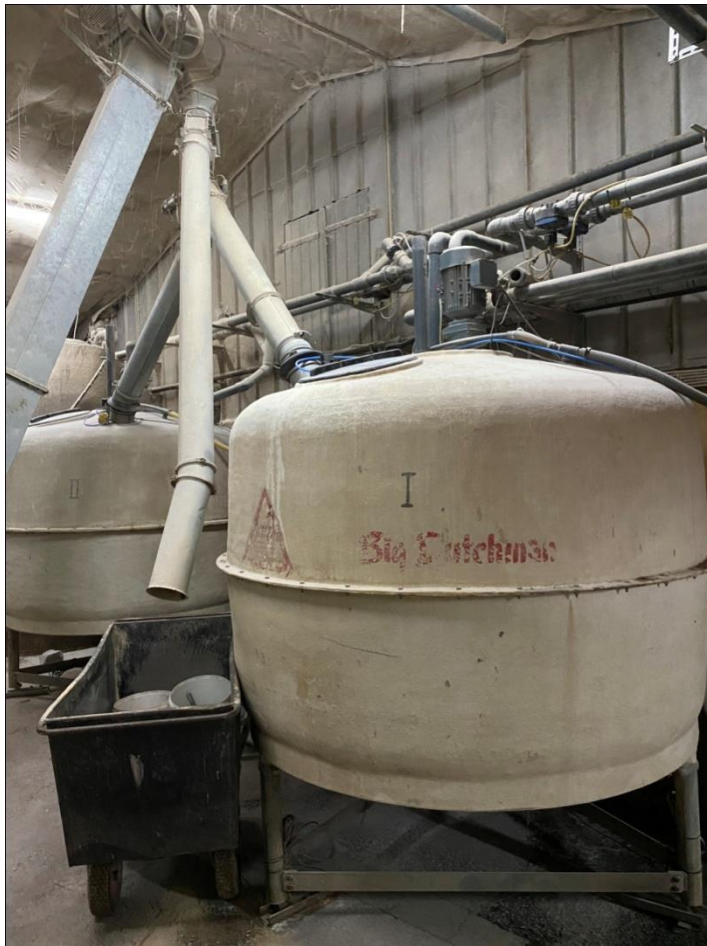
Рис.3.6. – Система приготування та транспортування кормів
