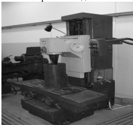
Рис. 10. Установка для випробовування на зносостійкість
