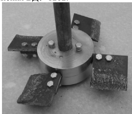
Рис. 9. Вал-тримач з дослідними зразками
