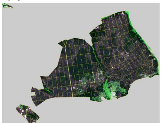
Рис. 3.61. Результати застосування методу максимальної подібності з синтезом каналів 2/3/4/8 для багаточасових наборів даних Sentinel-2 на предмет виявлення осередків всихання соснових насаджень
