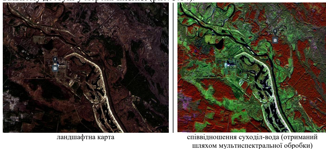
Рис. 3.14. Космічні знімки Чорнобильського радіаційно-екологічного біосферного заповідника, 1 - отриманий з супутника Sentinel-2; 2 – після мультиспектральної обробки
