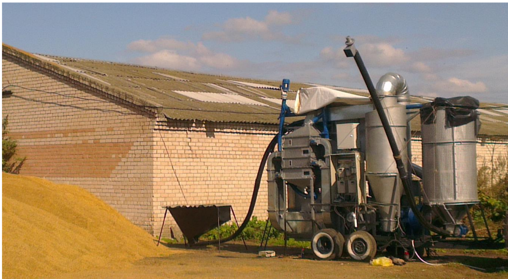
Рис. 2.13. Дослідний зразок мобільної універсальної шахтної аерожолобної сушарки СУША-М
