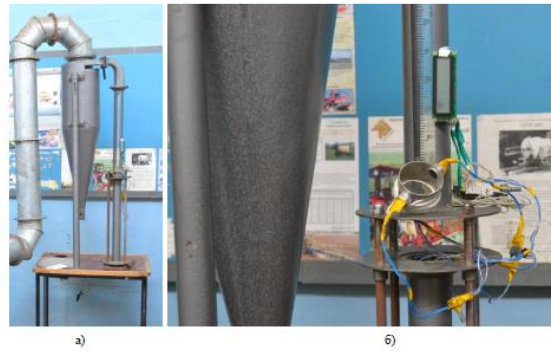
Рис. 2.6. Лабораторна установка для визначення діапазонів застосування ультразвуку при контролі зміни порізності псевдозрідженого шару зерна та насіння трав: а – загальний вигляд установки; б – блок вимірювання та ультразвукові датчики
