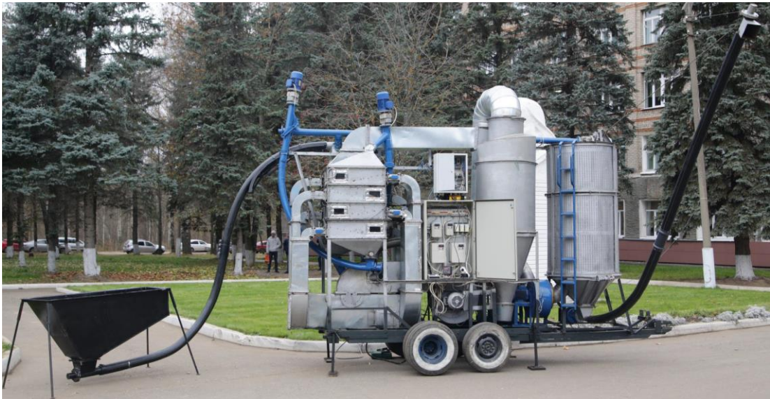
Рис. 2.12 Дослідний зразок мобільної універсальної шахтної аерожолобної сушарки СУША-М із вдосконаленою конструктивно-технологічною схемою
