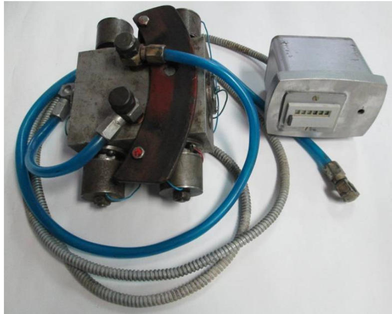
Рис. 2.1. Загальний вигляд експериментального поршневого витратоміра
