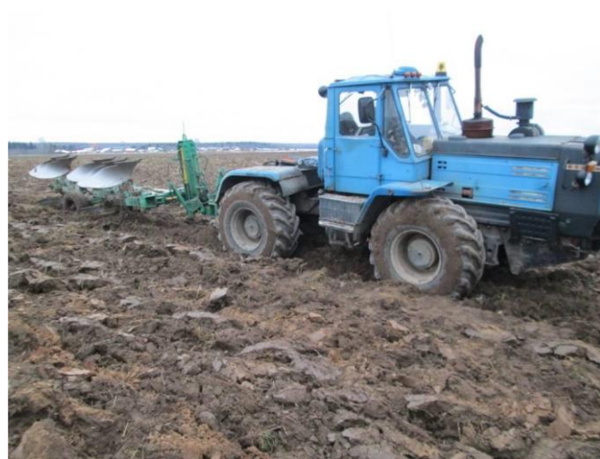
Рис. 2.15. Трактор Т-150К з плугом ППО-4+1
