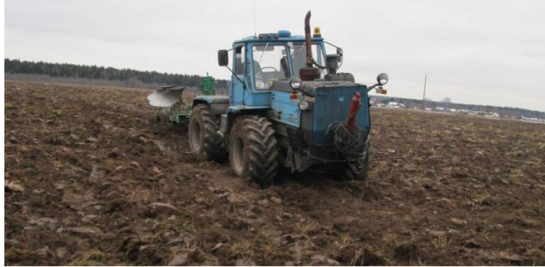
Рис. 3.14. Трактор Т-150К з плугом ППО – 4+1 на оранці
