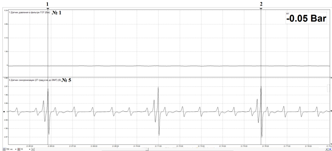
Рис. 3.6. Фрагмент осцилограми зміни розрядження у фільтрі грубого очищення палива двигуна Д-240, при частоті обертання колінчастого валу n = 1000 хв -1 : № 1 – датчик тиску у фільтрі грубого очищення палива; № 5 – датчик синхронізації (27 градусів до ВМТ)
