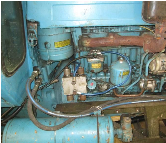
Рис. 3.10 Установка поршневого витратоміра на трактор МТЗ-82
