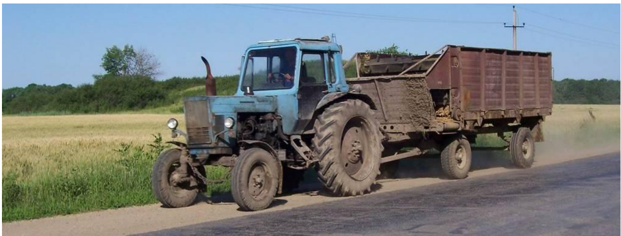
Рис. 3.13. Трактор МТЗ-80 с кормороздавачем КТУ-10.
