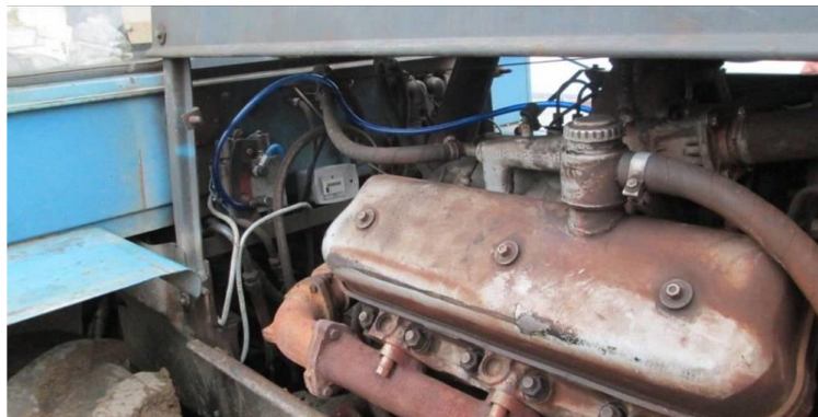
Рис. 3.15. Установка поршневого витратоміра на трактор Т-150К
