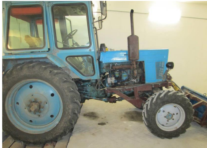
Рис. 2.13. Трактор МТЗ-82 на барабанному стенді
