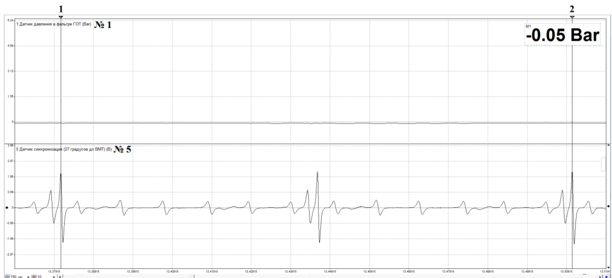
Рис. 3.5. Фрагмент осцилограми зміни розрядження у фільтрі грубої очистки палива двигуна Д-240, при частоті обертання колінчастого валу n = 700 хв -1 : № 1 – датчик тиску у фільтрі грубої очистки палива; № 5 – датчик синхронізації (27 градусів до ВМТ)
