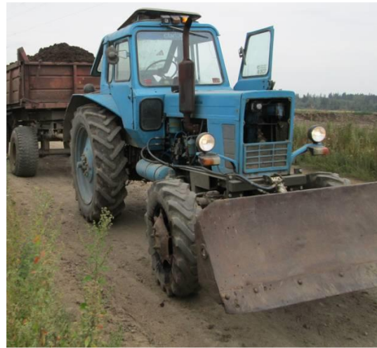
Рис. 3.11. Трактор МТЗ-81 з витратоміром на транспортних роботах
