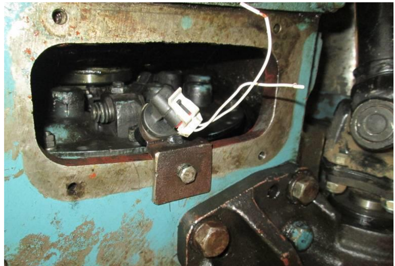
Рис. 2.8. Установка датчика Холла в оглядовий люк кожуха зчеплення
