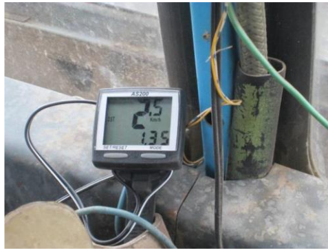
Рис. 3.16. Установка AS-200 у кабіні трактора Т-150К
