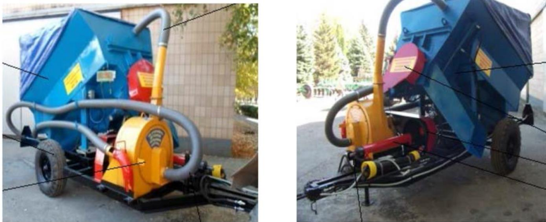
Рис. 1.6. Агрегат комбікормовий мобільний АКМ-3М: 1 – змішувач; 2 – ходова частина; 3 – вивантажувальне вікно із заслінкою та скатним лотком; 4 – привід змішувача; 5 – дробарка зерна; 6 – контрпривід; 7 – клинопасова передача; 8 – карданний вал; 9 – всмоктувальний рукав; 10 – нагнітальний трубопровід
