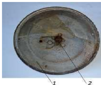
Рис. 3.8. Кришка мембранного насоса з лопатево зворотнім клапаном.
