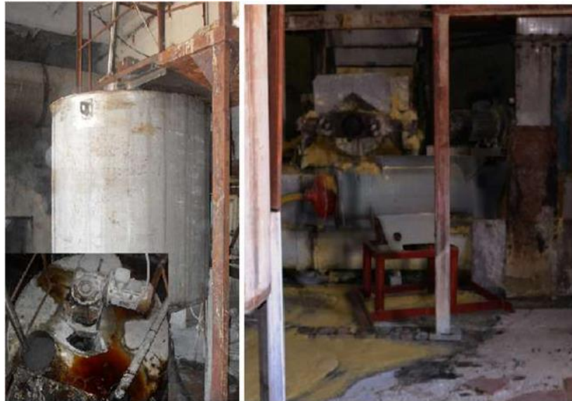
Рис. 3.12 Виробничі зразки нейтралізатора ЗКЕ та шнеко-лопатевого змішувача при випробуванні.
