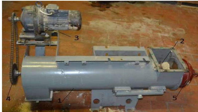
Рис. 3.10. Виробничий зразок шнеко-лопатевого змішувача ВКК : 1 – корпус; 2 – робочий орган; 3 – мотор-редуктор; 4 – ланцюгова передача; 5 – мембранний насос ЗКЕ.
