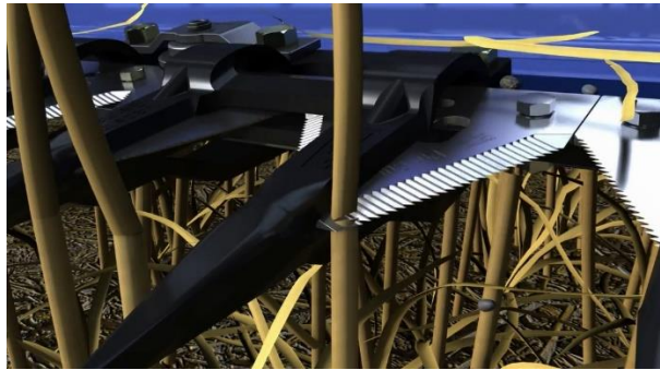
Рис. 1.6. Модель різального апарату сегментно-пальцевого типу з використанням протирізальних пальців Шумахера
