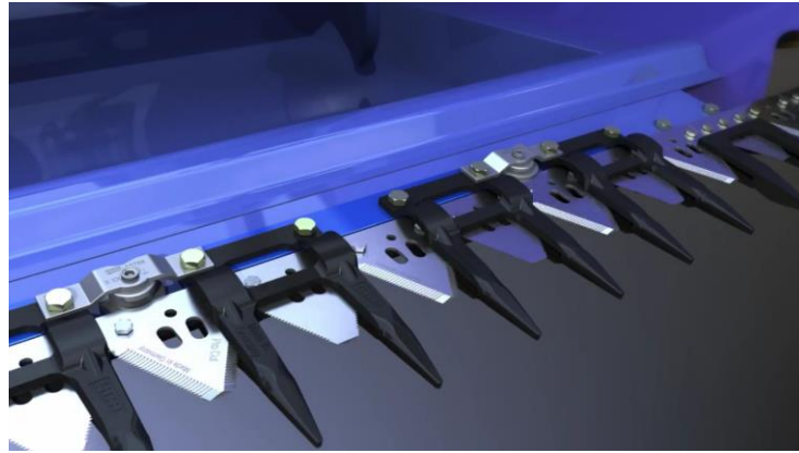
Рис. 2.3. Схема встановлення сегментів відносно пальців
