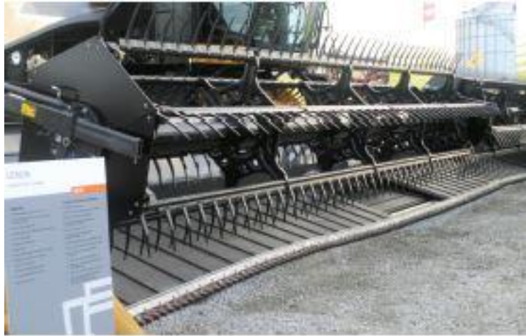
Рис. 1.3. Жатка обладнана стрічково-планчастим транспортером
