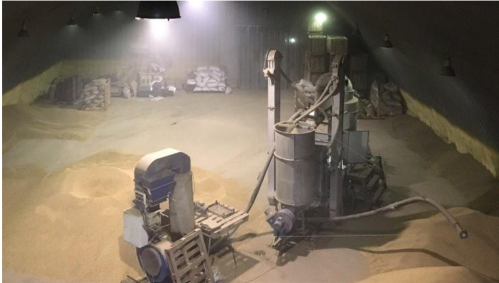
Рис. 2.14. Досвідчений зразок ПСК, оснащений пристроєм миттєвого контролю рухомого шару зернового вороху за допомогою ультразвуку.
