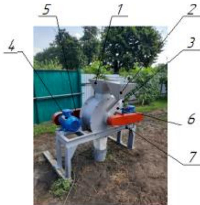
Рис. 2.3. Дробарка пророщеного зерна: 1 – центральний бункер; 2 - бункер бічний; 3 – шафа управління; 4 – електродвигун; 5 – кожух захисний; 6 – камера дробильна; 7 – рама.
