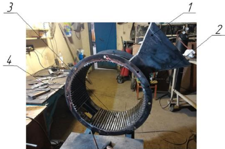
Рис. 2.2. Дробильна камера експериментальної дробильної установки для пророщеного зерна 1 – завантажувальний бункер центральний; 2 – корпус камери дробильної; 3 – дека; 4 – вікно вивантажене.
