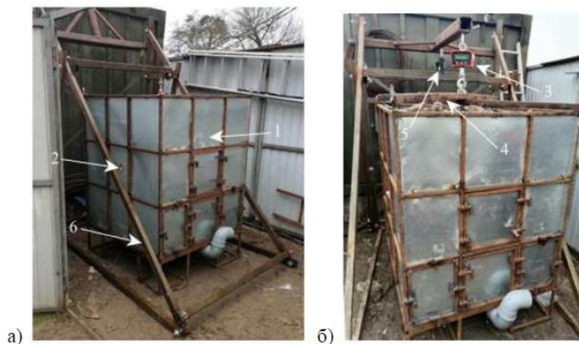
Рис. 2.6. Експериментальна установка для проведення досліджень тепломасообмінних процесів у масиві коренеплодів : а – установка у процесі завантаження; б – при зважуванні 1 – ємність для зберігання коренеплодів; 2 – труби розміщення датчиків; 3 – ваги підвісні; 4 – траверса; 5 – підйомний механізм; 6 – каркас
