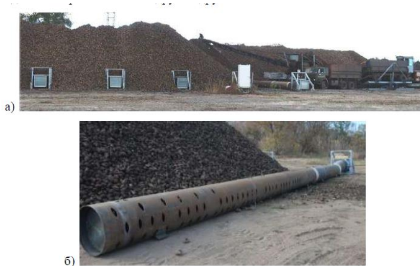
Рис. 2.1. Кагат, оснащений системою активної вентиляції: а – формування кагату за допомогою буртоукладальної машини; б - вентиляційна гілка
