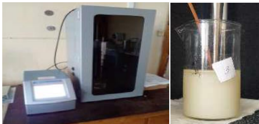
Рис. 2.2. Зовнішній вигляд лабораторної установки Qsonica sonicators Q700: А) загальний вигляд ультразвукової камери Б) Синтез біодизельного палива та панелі управління
