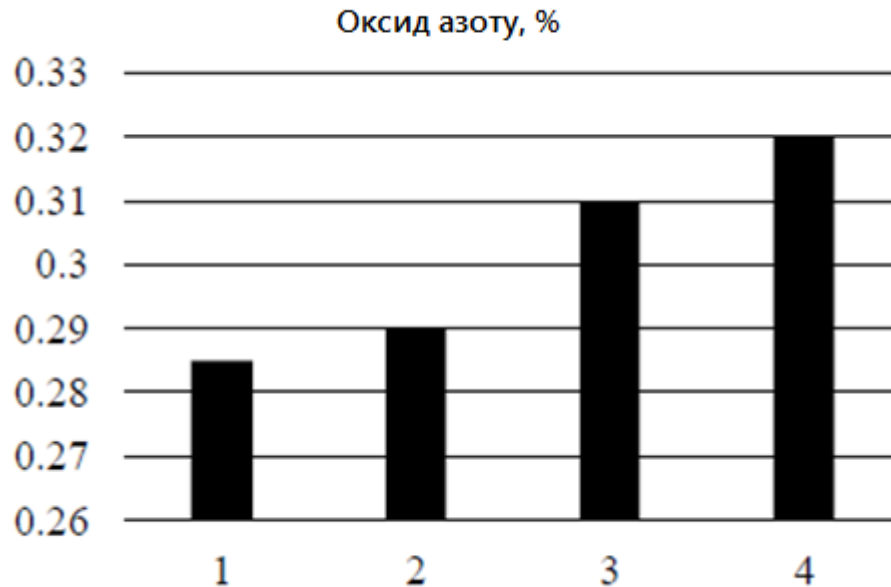
Рис. 3.10 – Зміна оксидів азоту відпрацьованих газів: 1 – дизельне паливо; 2 – 20% дизельне змішане паливо; 3 – 30% дизельне змішане паливо; 4 - 50% дизельне паливо.
