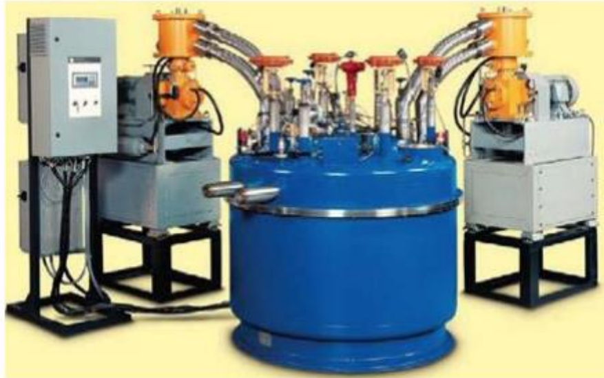
Рисунок 1.10 – Зовнішній вигляд системи циркуляційного охолодження Stirling LPC 2 FF (1700 Вт за 77 К)
