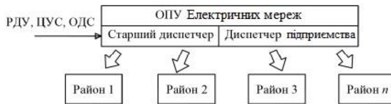
Рисунок 2.6 – Принцип оперативного керування електричними мережами
