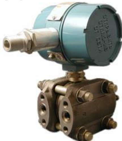
Рис. 2.2. Датчиків тиску використовуються термоелектричні перетворювачі типу Сапфір 22 М-ДА
