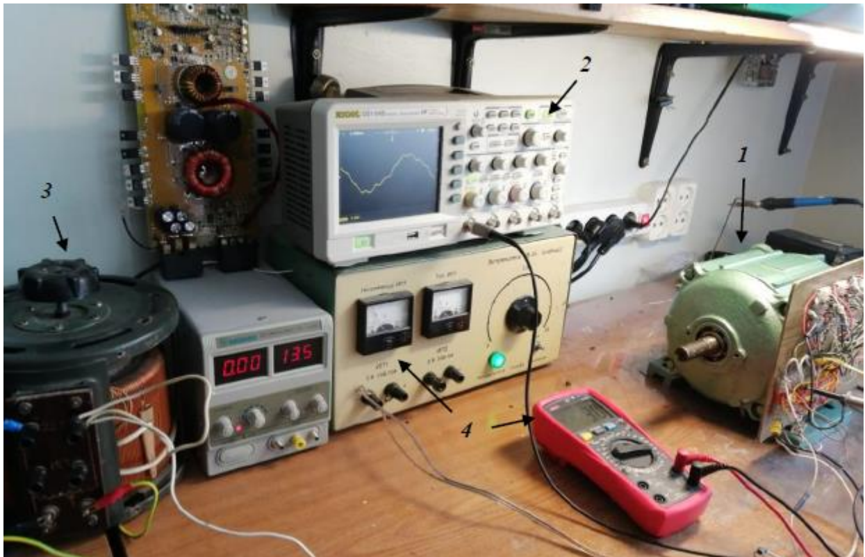
Рис. 3.1. Зовнішній вигляд випробувального стенду: 1 – ТОМП; 2 – осцилограф; 3 – латр; 4 – вимірювальні прилади
