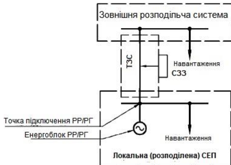
Рисунок 1.1 - Структура міжсистемних з'єднань [92]
