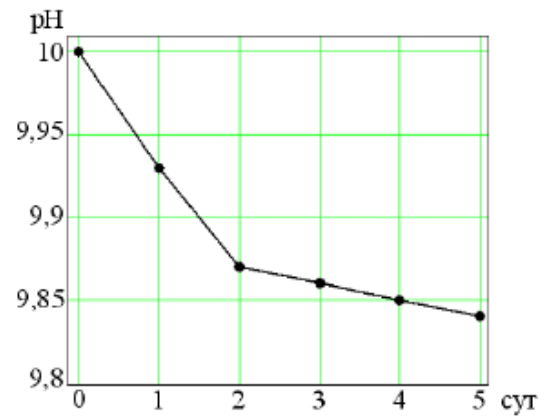
Рис. 3.5. Залежність зміни водневого показника pH від часу вироблення верстата
