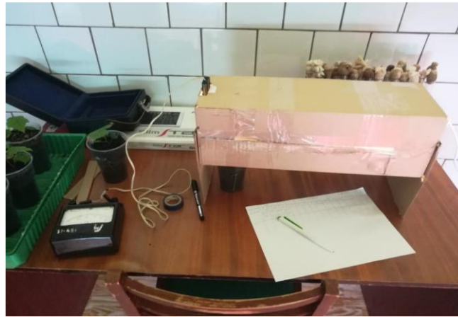
Рис. 2.2 Загальний вигляд приладу проектора для визначення загальної площі листя мікроклональних рослин на етапі ex vitro .
