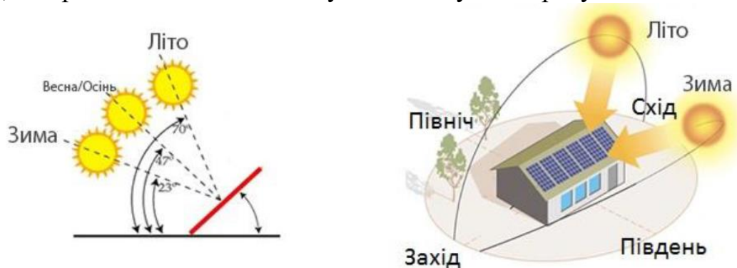
Рис 2.1 Оптимальне розташування сонячних панелей, в залежності від горизонту і кута нахилу
