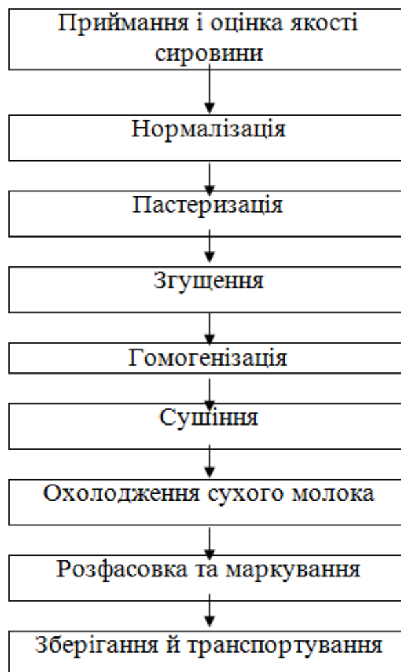
Рис. 9. Технологічна схема виробництва сухого молока
