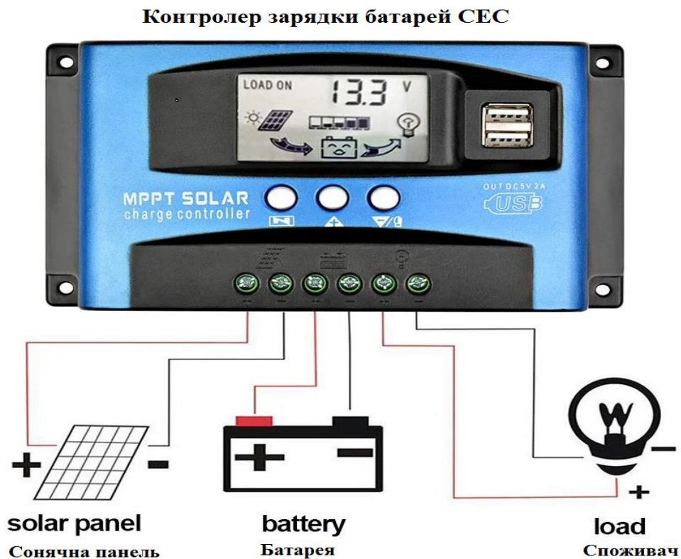
Рисунок 2.2 – Схема взаємодії контролер заряду сонячних батарей з СЕС.
