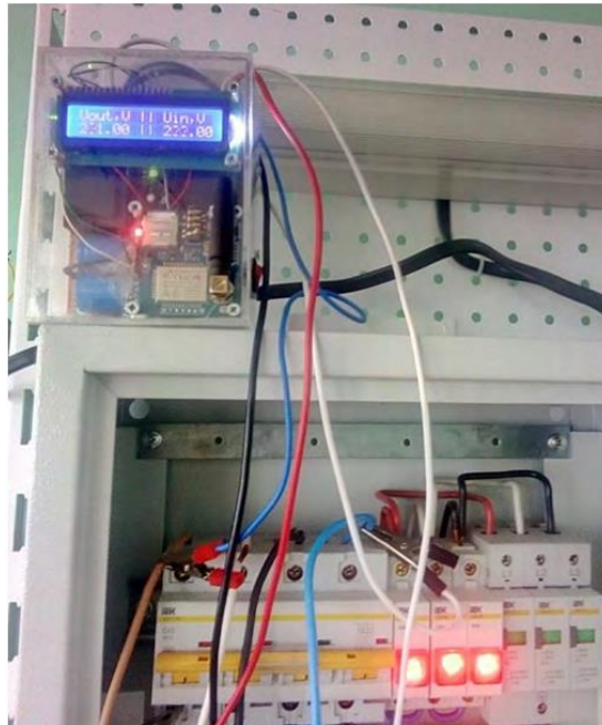
Рис. 3.3. Підключення ПККТВтаВН до блоку імітації введення споживача та навантаження.
