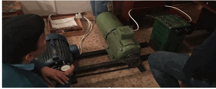
Рис. 3.7. Випробування АТ у генераторному режимі
