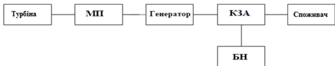
Рис. 1.1. Основні установки мікро-ГЕС
