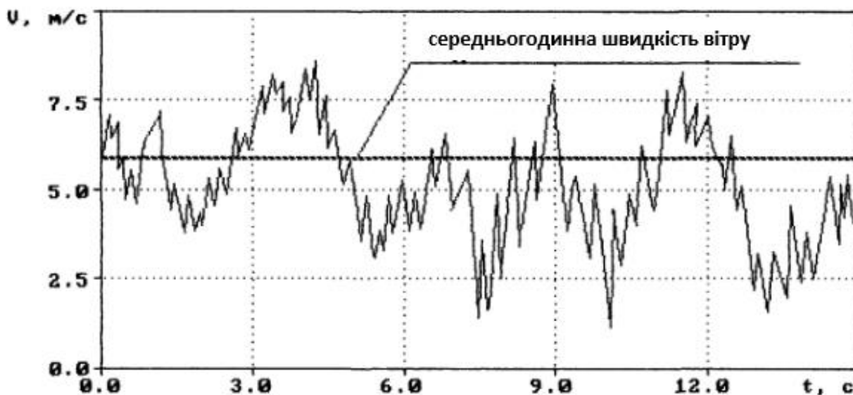
Рис. 2.3. Зміна швидкості вітру за 15 с при середньогодинному значенні 6 м/с
