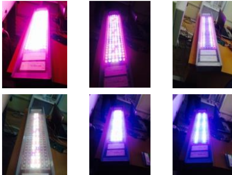
Рис. 2.8. Зміна спектрального складу та спектральної інтенсивності випромінювання СДС.
