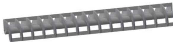
Рис. 2.2. Шнек із лопатками, ізометрія
