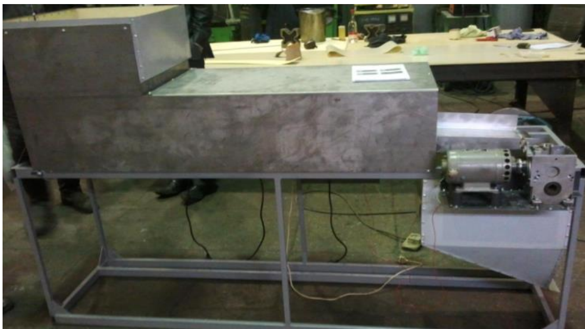
Рис. 2.4. Зовнішній вигляд експериментальної установки з НВЧ-модулем для проведення передпосівної обробки насіння дерев хвойних порід Лінія розрахована на роботу в закритих виробничих приміщеннях, забезпечених електроенергією та холодною водою для технологічних потреб.
