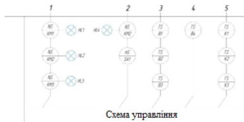
Рис. 3.2. Електрична схема керування системою підігріву води в корівнику
