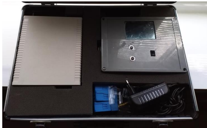
Рис. 2.9. Зовнішній вигляд пристрою ТЕМП-3-В із використанням Wi-Fi технології передачі даних
