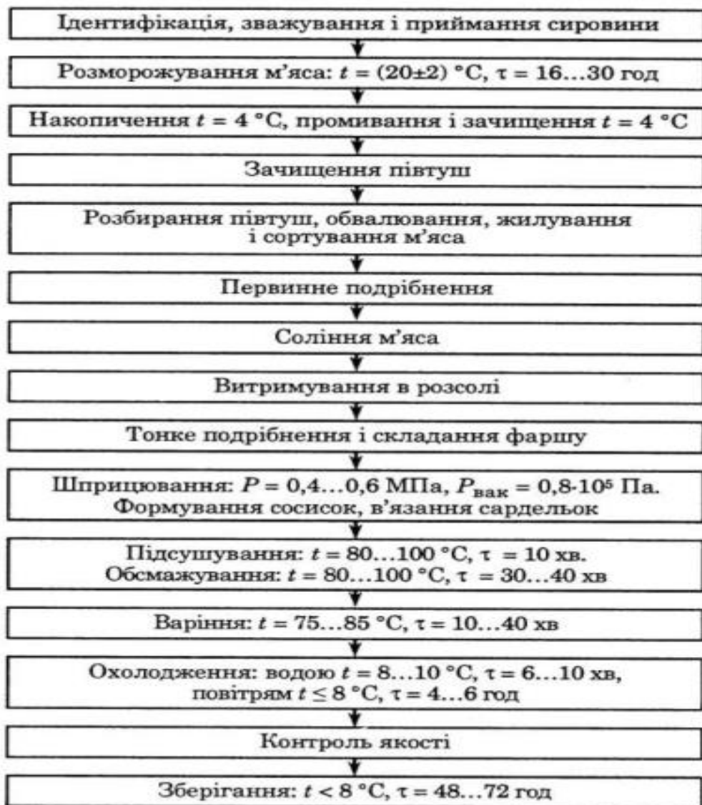
Рис. 12. Технологічна схема виробництва сардельок «Екстра»
