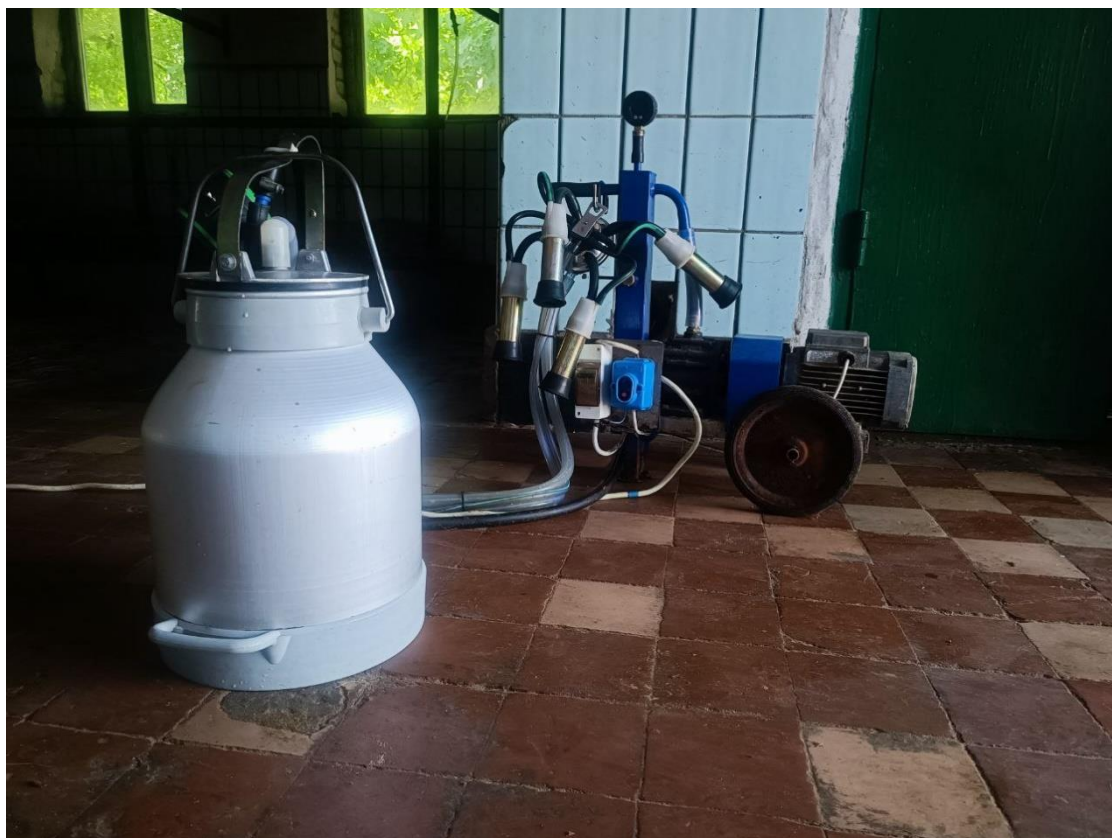
Рис. 3.2. Доїльний апарат Дамілк АІД-2 «Євро 240», що застосовується для доїння корів в умовах навчально-наукової лабораторії
