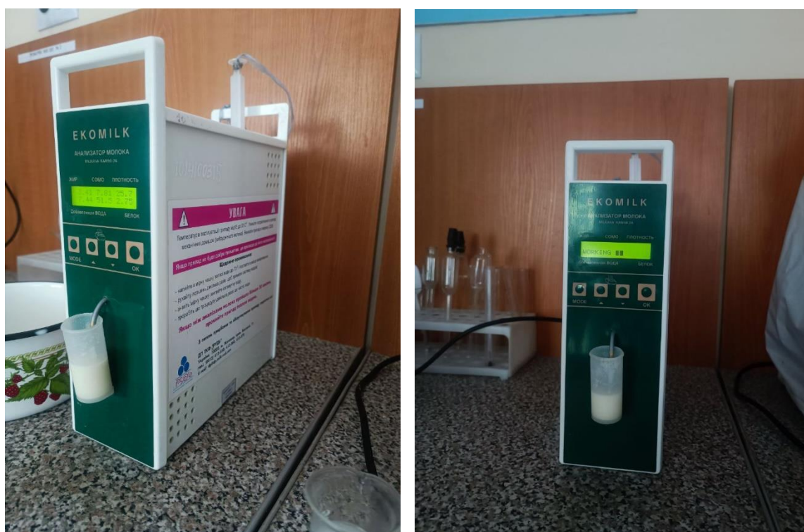
Рис. 2.6. Аналізатор «ЕКОМІЛК Milkana КАМ98-2А» в процесі дослідження молока
