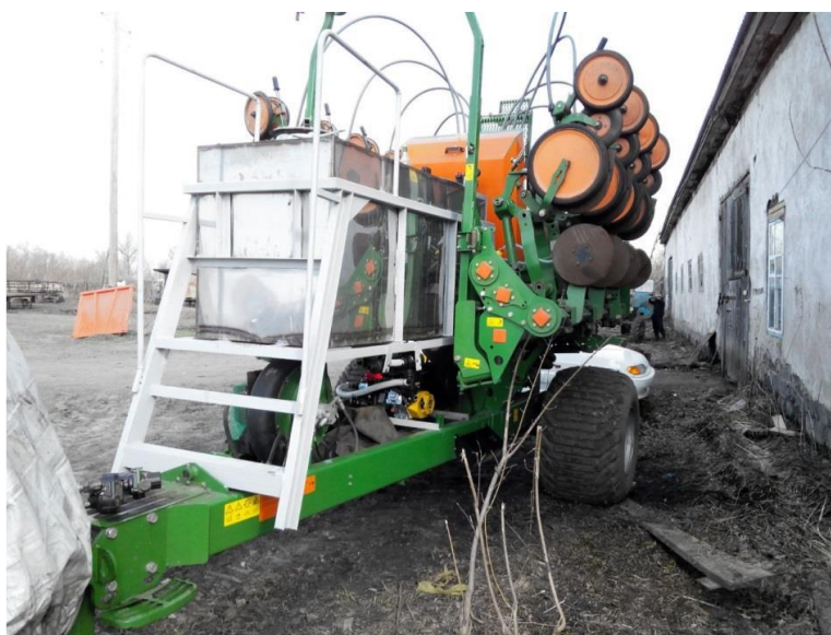
Рис. 1.3. Модернізована сівалка EDX-6000, обладнана для внесення рідких добрив
