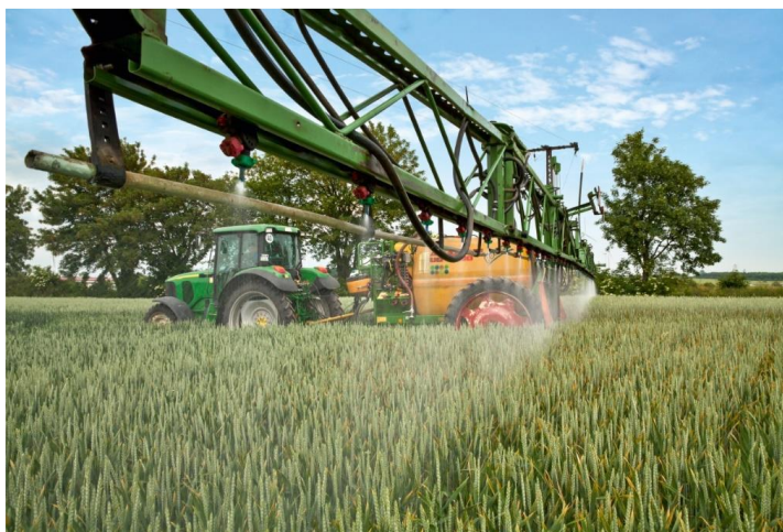
Рис. 1.4. Обприскувач причіпний "Амазоне"
