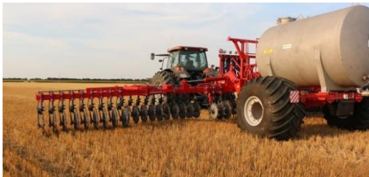
Рис. 1.6. Ліквілайзер ІКП-13554/8,5 шириною 13,5 м з ємністю 8500л.
