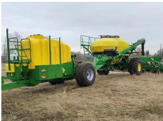
Рис. 1.2. Причипний універсальний агрегат для внесення рідких добрив (ВРД).
