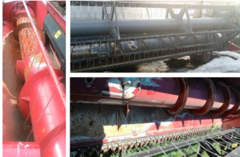
Рис. 3.6. Жатки зернозбиральних комбайнів після одного сезону експлуатації
