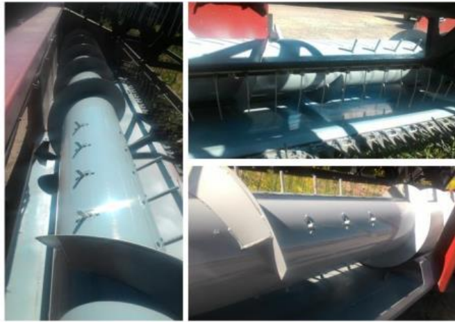
Рис. 3.11. Пофарбовані за розробленим технологічним процесом жатки зернозбиральних комбайнів.
