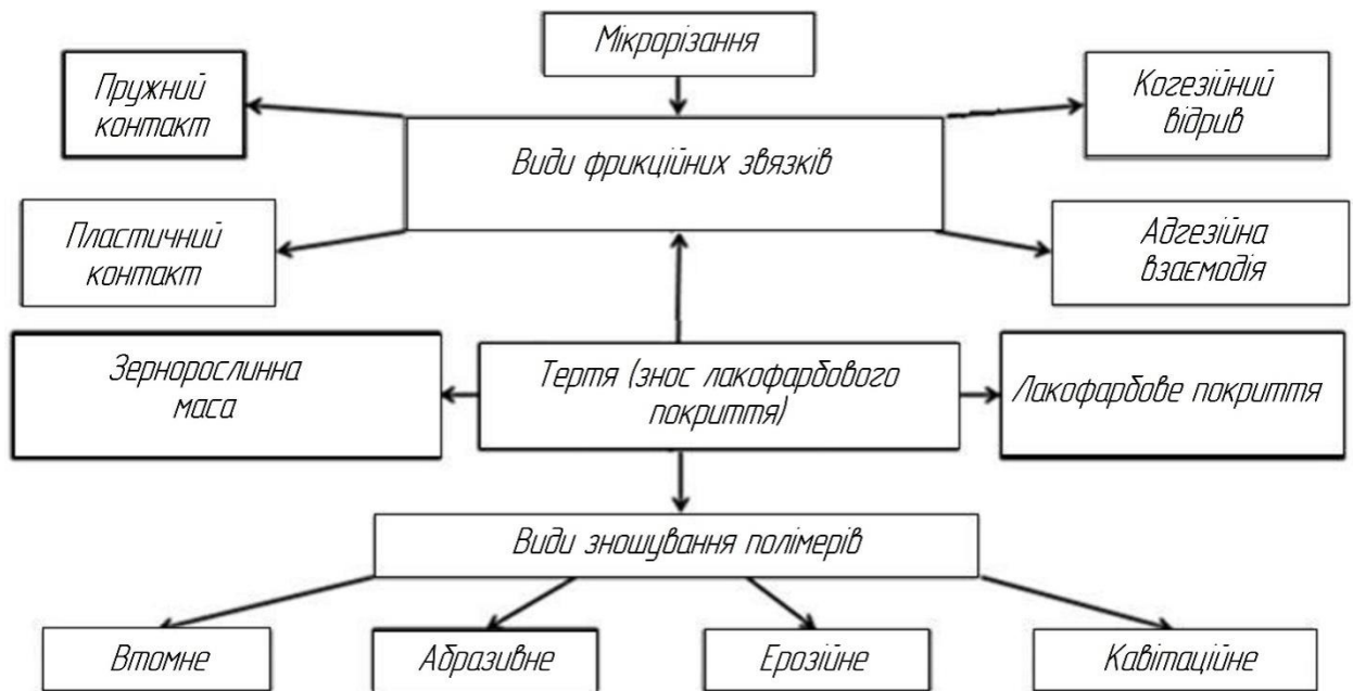
Рис. 2.1. Види фрикційних зв'язків і зношування полімерів
