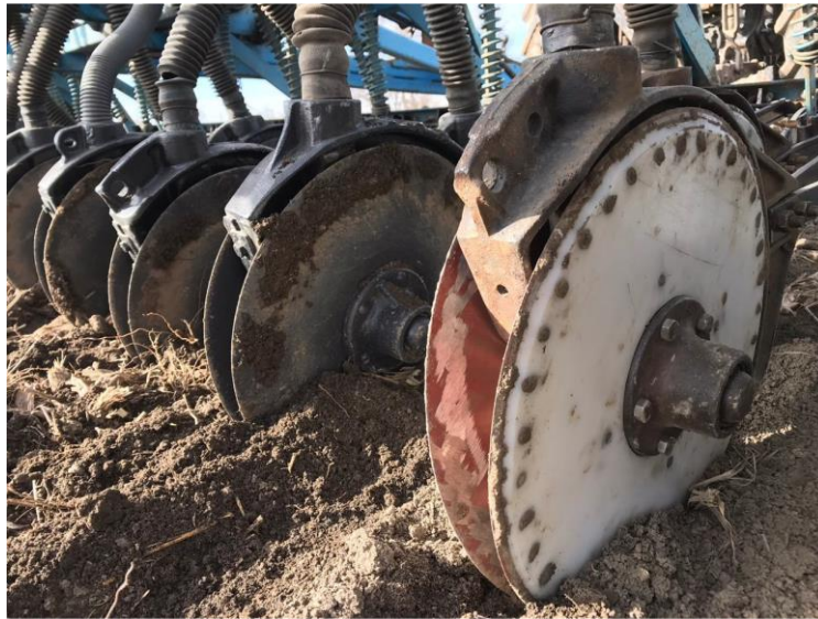
Рис. 3.2. Вид модернізованого та стандартних широкорядних (однорядкових) сошників сівалки СЗ-3,6 після роботи
